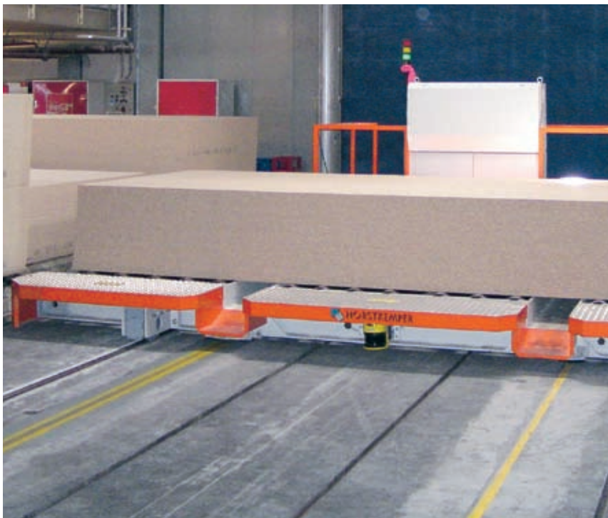
Der Sicherheits-Laserscanner S3000 und das Positioniersystem KH53 sichern den Fahrweg und bestimmen die Position von Verschiebewagen
