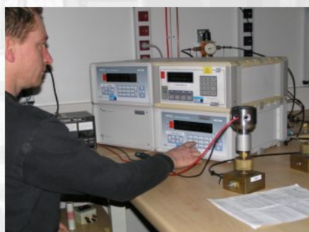
Gerätemontage Ausgangsprüfung mit Kalibrierprotokoll
