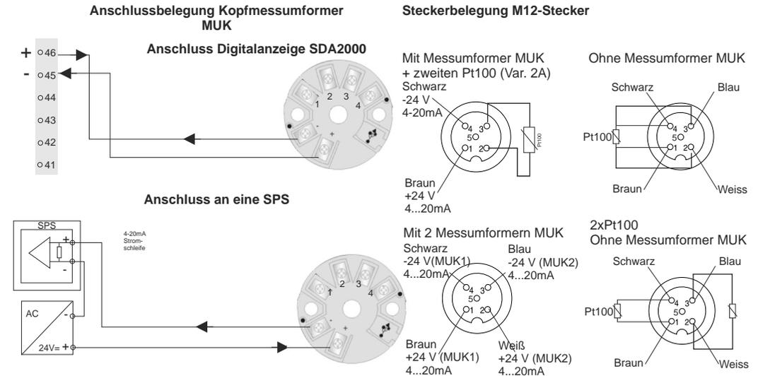
\*Hinweis: Zur Parametrierung des Kopfmessumformers muss dieser ext. mit Spannung versorgt werden oder vom einem 2-Drahtumformer gespeist sein\*
